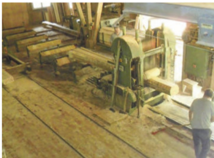
Die Gattersäge zum Einschneiden des Rundholzes für Kanthölzer, Bretter, Latten.
